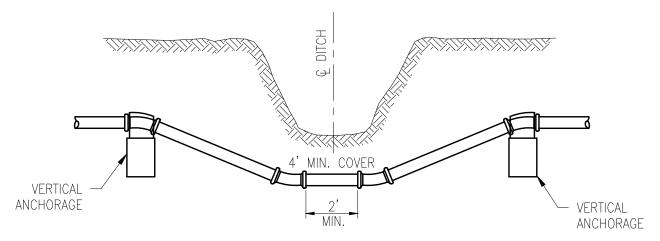
USE FIELD-LOK GASKETS AT ALL NECESSARY NON-MECHANICAL JOINTS PER APPROVED RESTRAINING SCHEDULE
